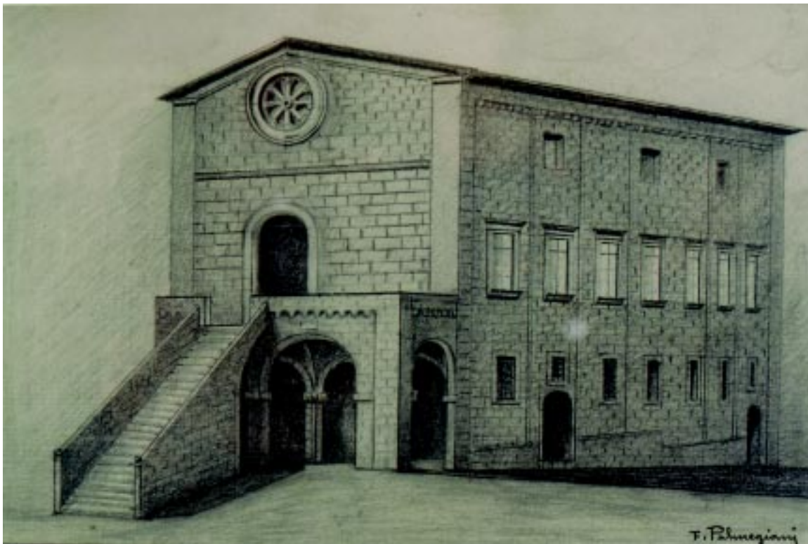
Disegno di Francesco Palmegiani per un progetto di restauro del palazzo papale di Rieti. Il progetto, nel prosieguo dei lavori, subì importanti modifiche. Lo scalone d'ingresso al salone papale fu costruito nel cortile interno, come si può vedere nella foto di pagina 5, mentre la loggetta non fu chiusa ma realizzata in elegante forma aperta con pilastri e colonne (Archivio privato di Dario Brucchiotti, Rieti)
